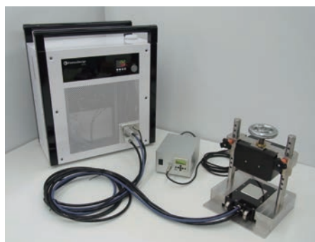
温調機 + 加圧治具
